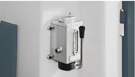
Lubricación. Se utiliza para mejorar efectivamente la suavidad de los movimientos de fijación en T
