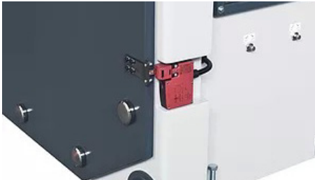
Interruptor de seguridad para evitar que el operador toque la hoja de sierra en movimiento
