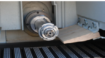
Rodillo liso superior a la entrada de la pieza
