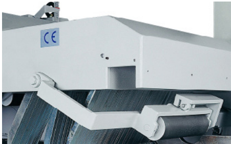
La cinta transportadora neumática de alimentación incorpora rodillos superiores e inferiores dentados para mayor eficiencia y seguridad en piezas de trabajo más pesadas
