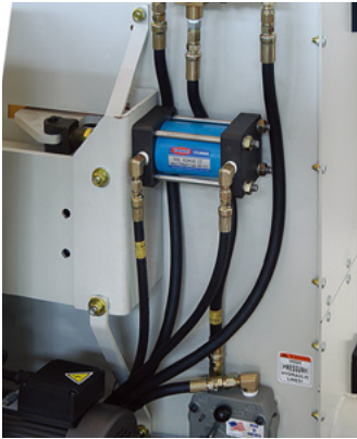
Sistema hidráulico/automático de la tensión de la hoja de sierra.
