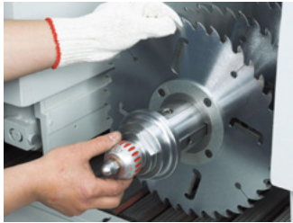
Sistema HIDRO-FIX de tuerca hidráulica manual (OPCIONAL)
