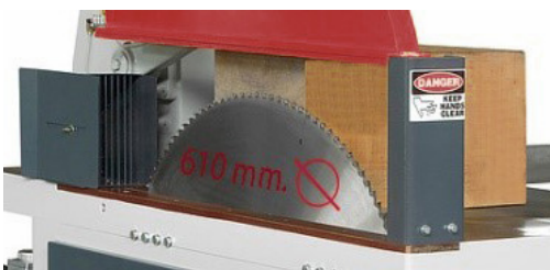
Disco de gran diámetro y cubierta de seguridad con prensor. Ideal para operaciones de corte rápido
