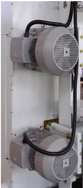
Tanto los volantes superiores como los inferiores están impulsados por 2 motores independientes que transmiten la máxima potencia a las hojas de sierra
