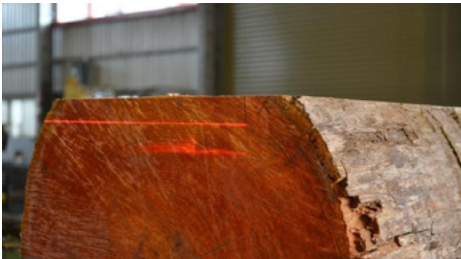
Láser para mostrar la capacidad de corte
