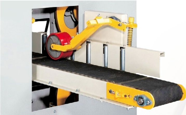
Rodillo transportador de alimentación reforzado Se aumenta considerablemente el tamaño para potenciar al máximo la rigidez y estabilidad.
