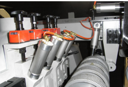
Zapatas de presión delanteras neumáticas
