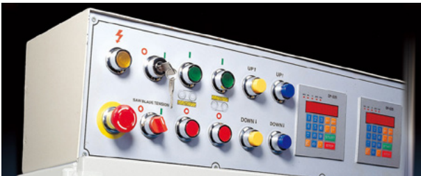
Panel de control centralizado con controlador digital del espesor para un posicionamiento automático de las hojas
